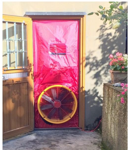
Abbildung 1: Schema für den  $Rn_{50}$ -Test im Differenzdruckverfahren
