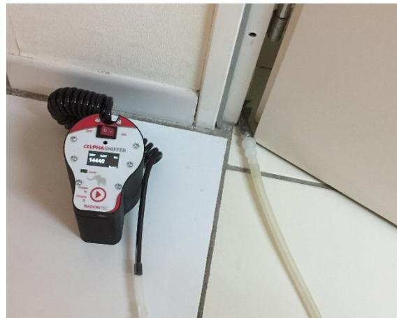
Abbildung 5: Radon-Sniffing an der Türzarge Kellerboden
